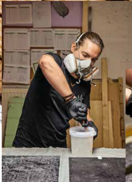
Epoxidharz im Einsatz: Patrick bestreicht eine Glasfasermatte mit der zähflüssigen Masse. Die Atemschutzmaske schützt ihn vor giftigen Dämpfen
